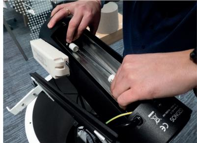
10. Legen Sie die UV-C-Leuchte zuerst rechts (Steckerseite) dann links in die Halterung. Schieben Sie anschließend die Leuchte ganz an dem Metallstab auf der linken Seite.
