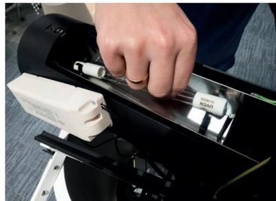
8. Heben Sie jetzt die UV-C-Leuchte zuerst links, danach rechts aus der Halterung und ziehen Sie die UV-C-Leuchte vorsichtig aus dem Stecker.
