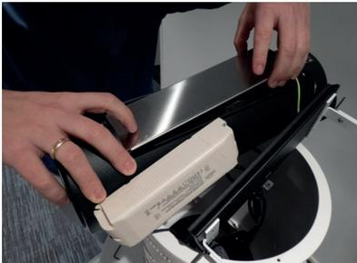
11. Legen Sie die Abdeckung des inneren Gehäuses so weit rechts wie möglich an und schieben Sie es dann nach links. Fixieren Sie es nun mit der Schraube.
