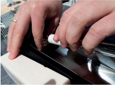
9. Nehmen Sie die neue UV-C-Leuchte und stecken Sie diese vollständig in den Stecker ein. Achten Sie auf die Ausrichtung der Kontakte.
