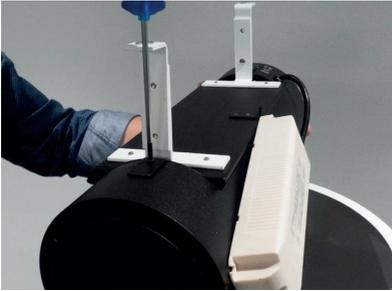
5. Entfernen Sie die zwei Schrauben auf der Unterseite des Geräts (eine links, eine rechts) und legen Sie die Abdeckung beiseite.
