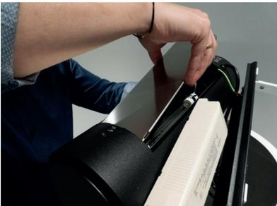
7. Schieben Sie das Gehäuse nach rechts, ziehen Sie es nach oben und legen Sie es danach beiseite.
