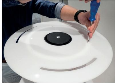
2. Auf der Oberseite der Hailey befinden sich drei Schrauben. Lösen Sie diese auf und entfernen Sie dann die aufliegende Platte.
