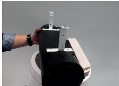
4. Stecken sie das AC-I Gerät aus dem Netzteil. Heben Sie nun den Luftreiniger gänzlich aus dem Zylinder. Dabei das obere Ende (erkennbar am Knopf) zur linken Seite ausrichten.
