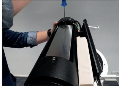
6. Schrauben Sie das innere Gehäuse auf. Die Schraube befindet sich am linken Ende.
